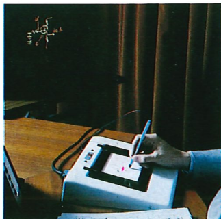
Crayon électronique permettant la visualisation sur écran de dessins, graphismes, etc.
