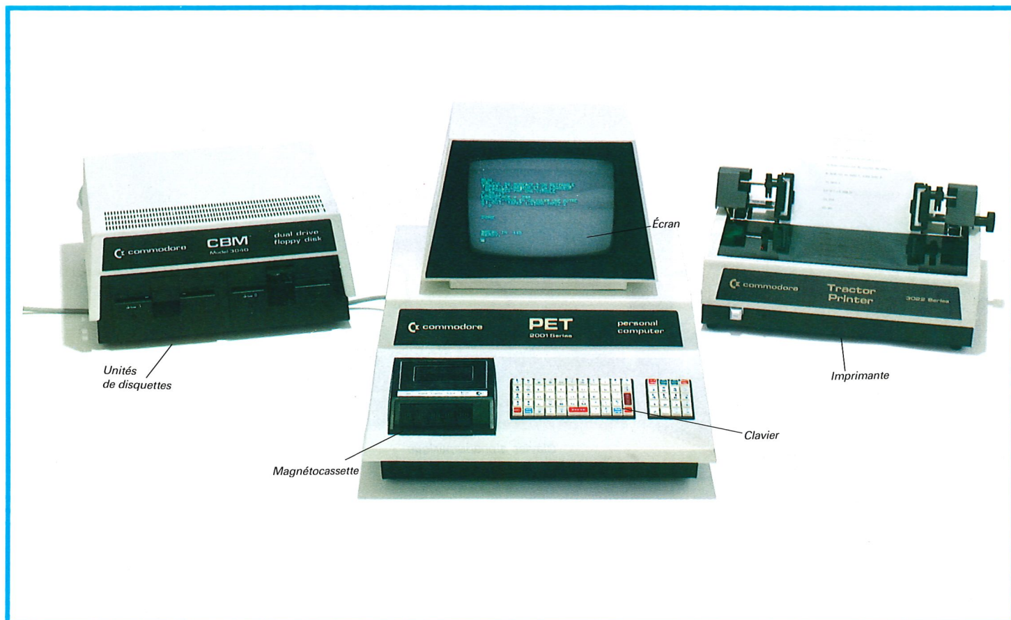
Pet série 2001 avec le magnétocassette, l'unité de disquettes et l'imprimante.
