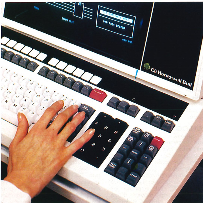
Clavier alphanumérique avec touches programmes (Cii Honeywell-Bull).
