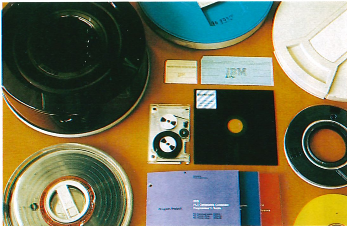
Support des informations, on distingue des bandes, disques, minidisques, qui permettent de mettre en mémoire les informations (IBM).
